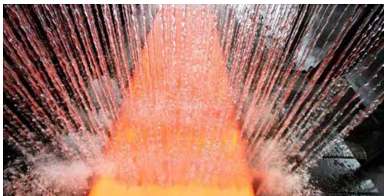
Figuur 2: Hete stalen band (oranje op de foto) afgekoeld door waterstralen na het warmwalsen.
