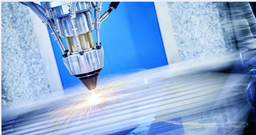
Figuur 1: Ponticon 3DMD: Een machine voor coating en volumetrische opbouw met hoge productiviteit.
