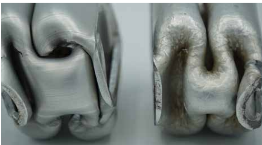
◀ Crashvervormingssimulatie van Al-onderdelen, links gebroken, rechts alleen vervormd!
